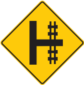
paso a nivel en la carretera de lado por delante - se prepare para parar
